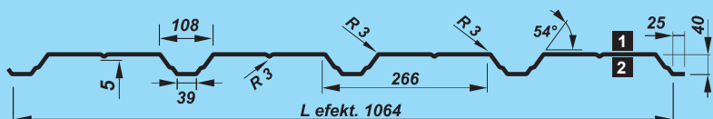
PROFIL ELEWACYJNY / KONSTRUKCYJNY
